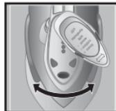
Brancher dans la prise de courant. Tourner le cadran de réglage des températures du tissu pour choisir le réglage du tissu désiré dans la gamme de vapeur de l'indicateur de température du tissu.
